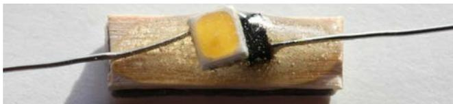
Im letzten Bild ist die fertige Einheit auf einem kleinen zugeschnittenem Stück Holz (Coffee to go Holz-Umrührstab) mit einem Epoxidharz-Schnellkleber verklebt. Das ganze ist somit vergossen und es werden die empfindlichen Lötstellen geschützt.
