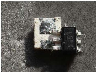
Die LED wird mit der Leuchtseite auf ein Stück doppelseitiges Klebeband aufgelegt und wie im Bild oben kommt hier im Beispiel der BCR 405 dazu. Im Bild rechts ist die fertig verlötete Einheit zu sehen. Das geht allerdings nur mit einem SMD-Lötkolben, einer Lupe und ein wenig Übung.
